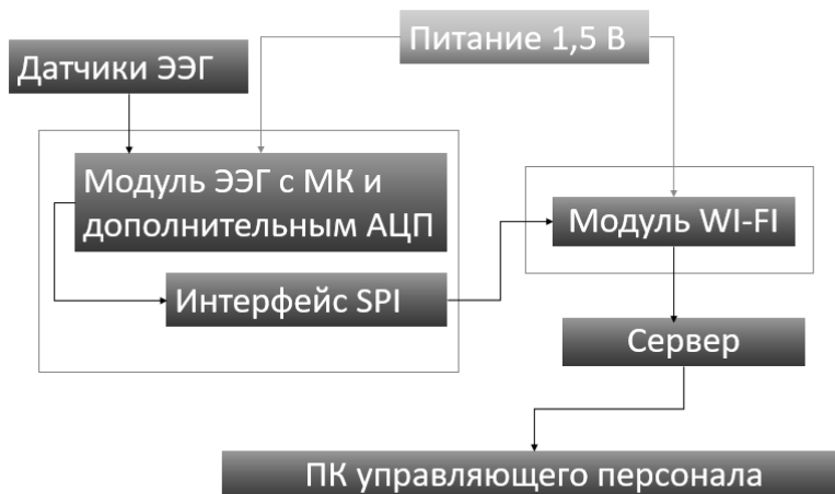
Рисунок 3. Блок-схема нейрокомпьютерного интерфейса
